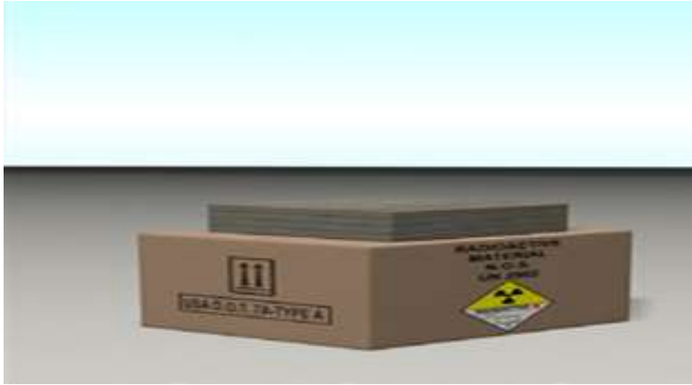
İSTİFLEME TESTİ Paket üzerine en az 24 saat boyunca, kendi ağırlığının beş katı kadar ağırlık konur.
