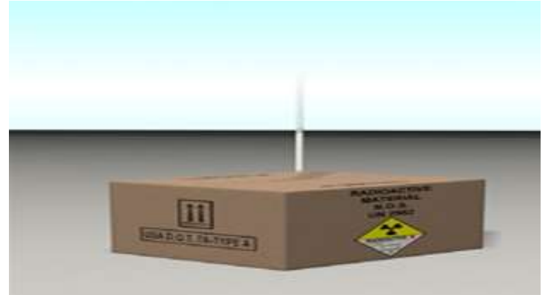
SERBEST DÜŞME TESTİ Paket, sert bir yüzeye belli bir yükseklikten serbest düşmeye bırakılır.
