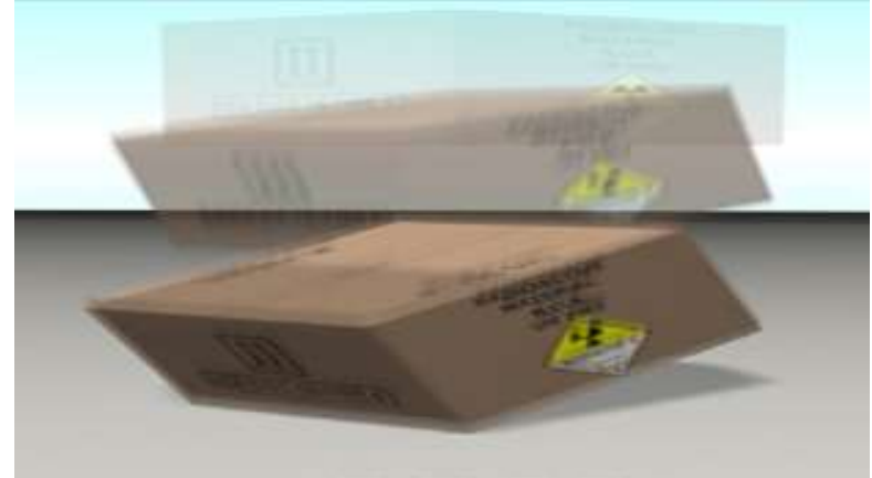
SERBEST DÜŞME TESTİ Paket, sert bir yüzeye belli bir yükseklikten serbest düşmeye bırakılır.
