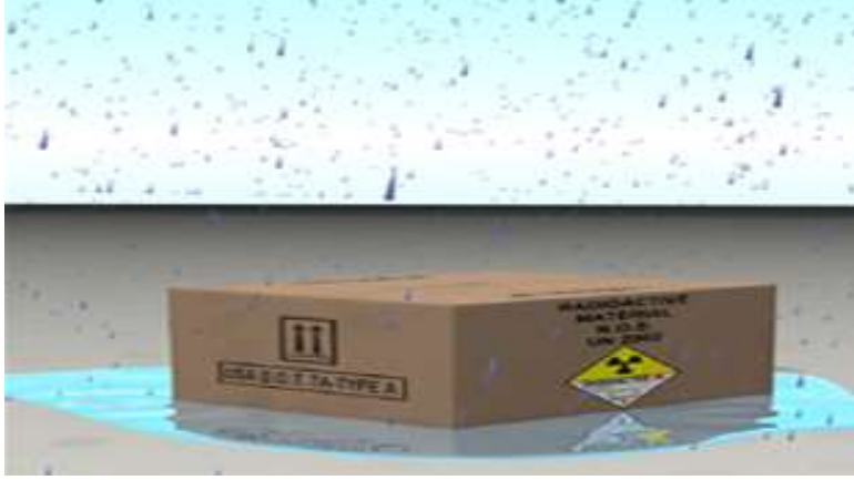
SU PÜSKÜRTME TESTİ Pakete bir saat boyunca su püskürtülür.
